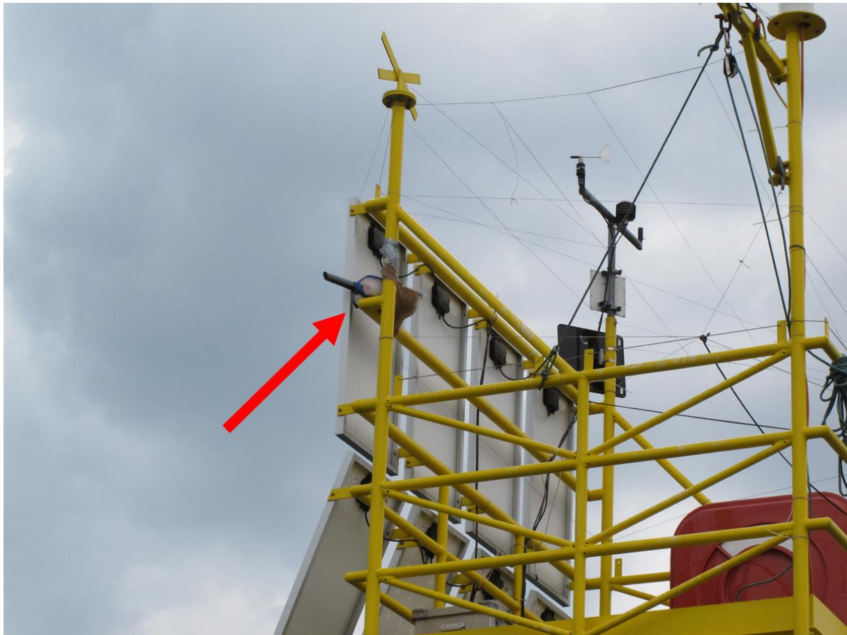
Abbildung 6: Arbeitsplattform Riff Rosenort mit montiertem Fledermauserfassungssystemen vom Typ Echtzeit-/Zeitdehnungsdetektor, Modell Batcorder (Mikrofon südlich ausgerichtet)
